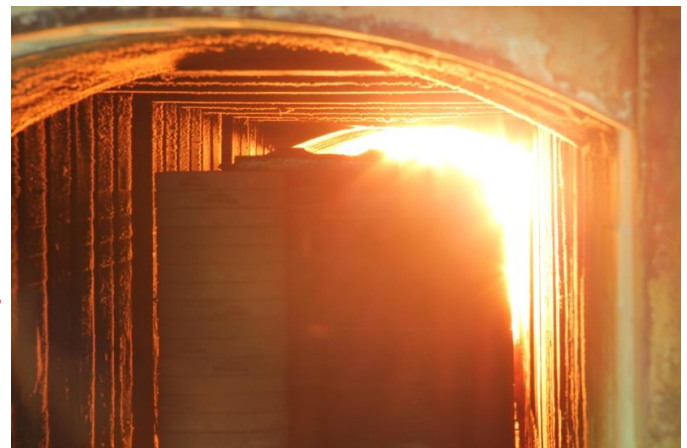
約1,460℃の高温で焼き上げる連続式焼成窯
